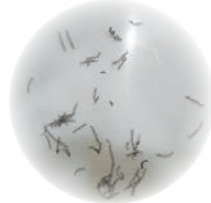
高圧クーラント(3MPa)の切りくず
